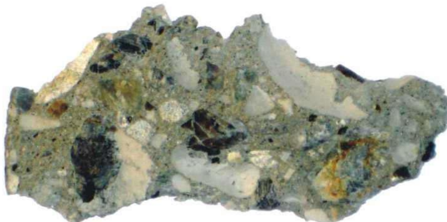
Рис. 1.1. Макроструктура бетона на песчано-гравийной смеси
