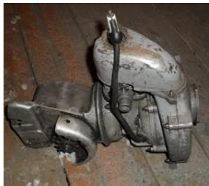
Двигатель бензопилы «Дружба-4»
