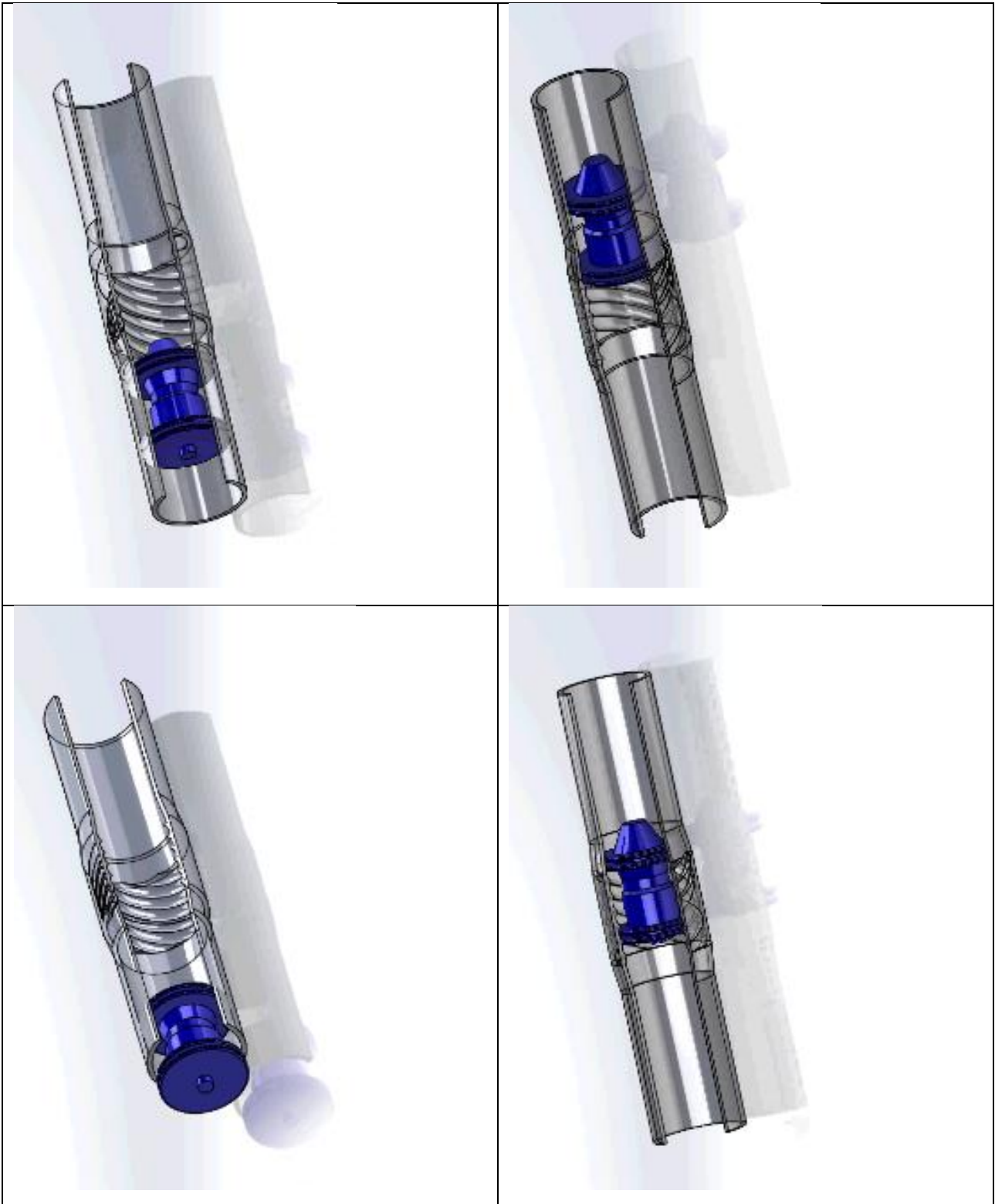
Рисунок 2 – Пояснение процесса прохождения устройства СОД через завихритель
