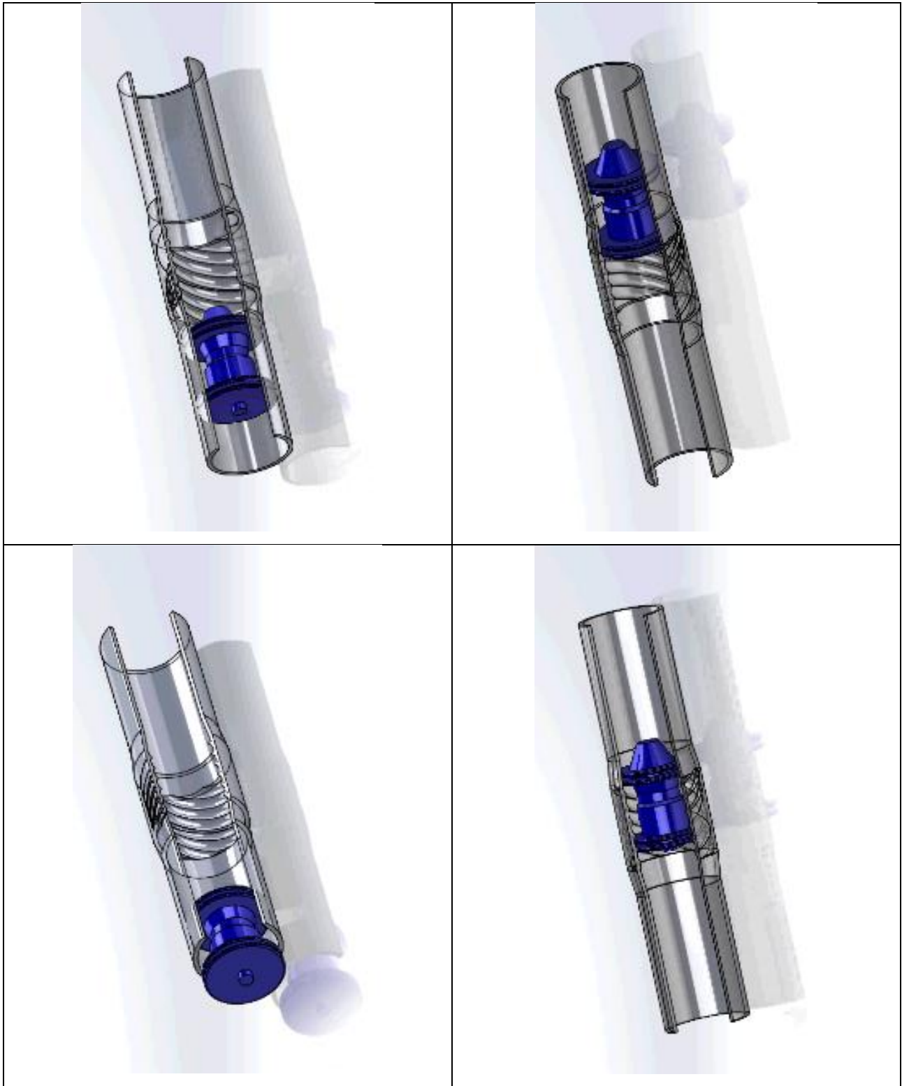
Рисунок 2 – Пояснение процесса прохождения устройства СОД через завихритель
