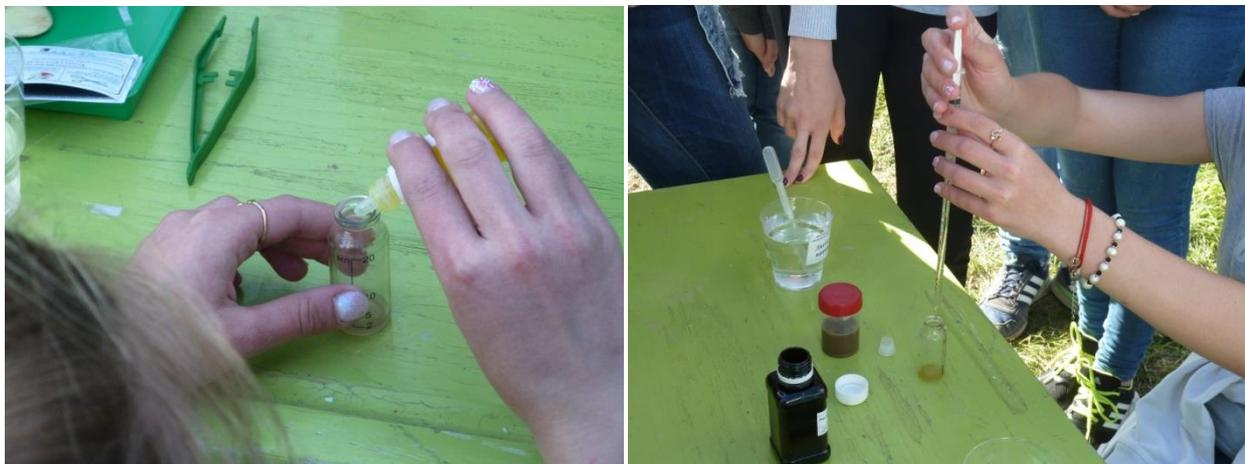
Рис. 1. **Определение ионов хлора в почвенной вытяжке в полевых условиях**
