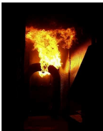
Рисунок 3. Имитатор горящий трубопровод
