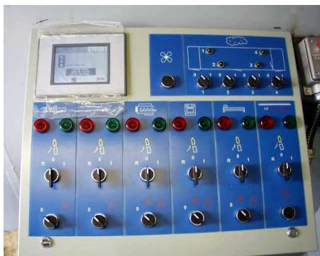
Рисунок 2. Внешний вид пульта управления пожарного модуля Dräger (Германия) с моделированием воспламенения на газе
