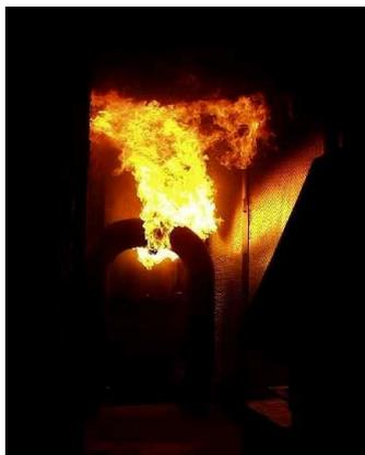
Рисунок 3. Имитатор горящий трубопровод
