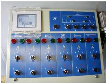
Рисунок 2. Внешний вид пульта управления пожарного модуля Dräger (Германия) с моделированием воспламенения на газе
