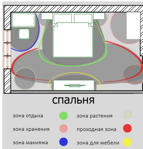
Рис.1 Схема зонирования территории на примере спальни
