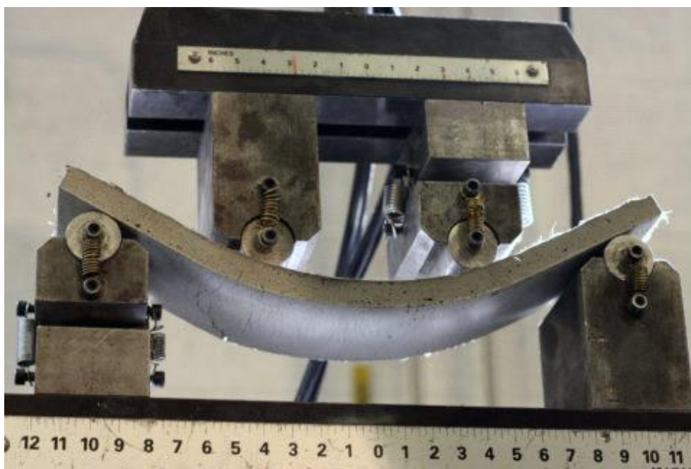
Рис.2. Образец эластичного бетона, проходящего испытание на изгиб.
