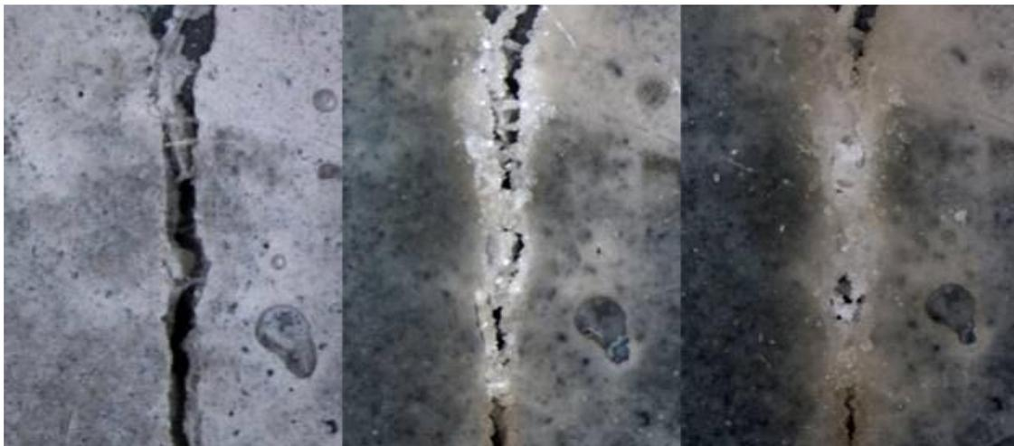
Рис. 1. Процесс "самолечения" бетона.
