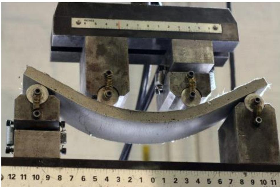
Рис.2. Образец эластичного бетона, проходящего испытание на изгиб.
