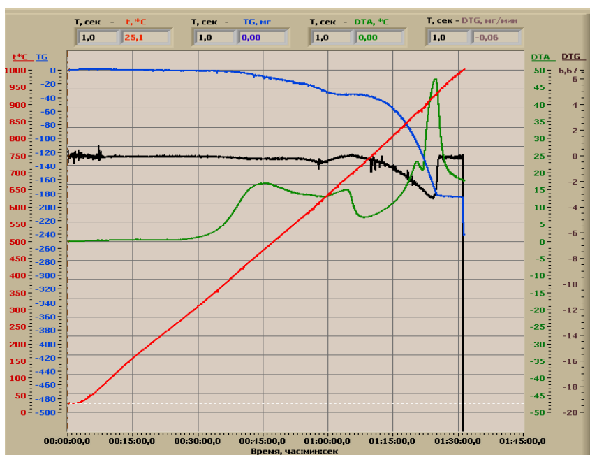
Рис.1. Типичные кривые при дериватографическом исследовании восстановления оксида свинца (II) углеродом (соотношение PbO:C = 1:1 ):
