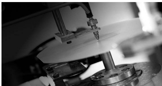
Рисунок 4. Обработка сапфира на шлифовальных станках
