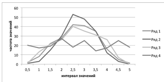
Рисунок 6. Графики плотности распределения значений погрешностей при различных соотношениях систематической и случайной составляющих: ряд 1 – при \mu=0 ; ряд 2 – при \mu=0,3 ; ряд 3 – при \mu=0,6 ; ряд 4 – при \mu=1
