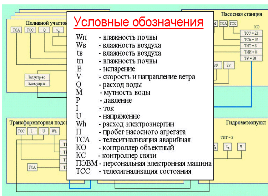
Рисунок 5. Структурно-функциональная схема АСУ ТП орошения
