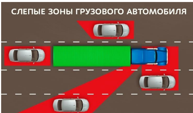
Рисунок 1. Слепые зоны грузовых автомобилей
