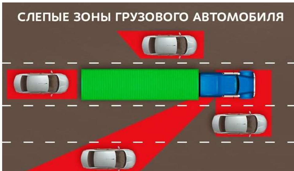
Рисунок 1. Слепые зоны грузовых автомобилей
