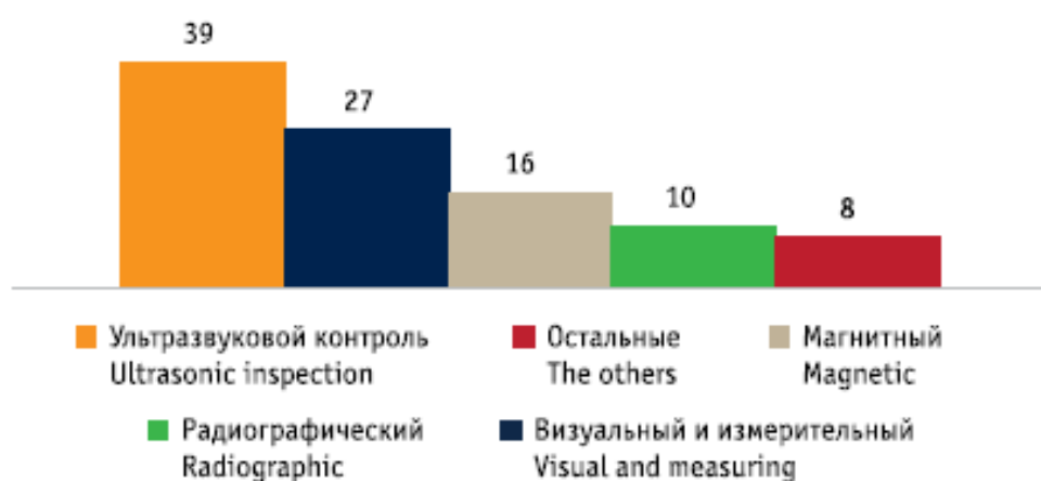
Рис. 1. Процентное соотношение применяемых методов НК при диагностике вертикальных стальных резервуаров
