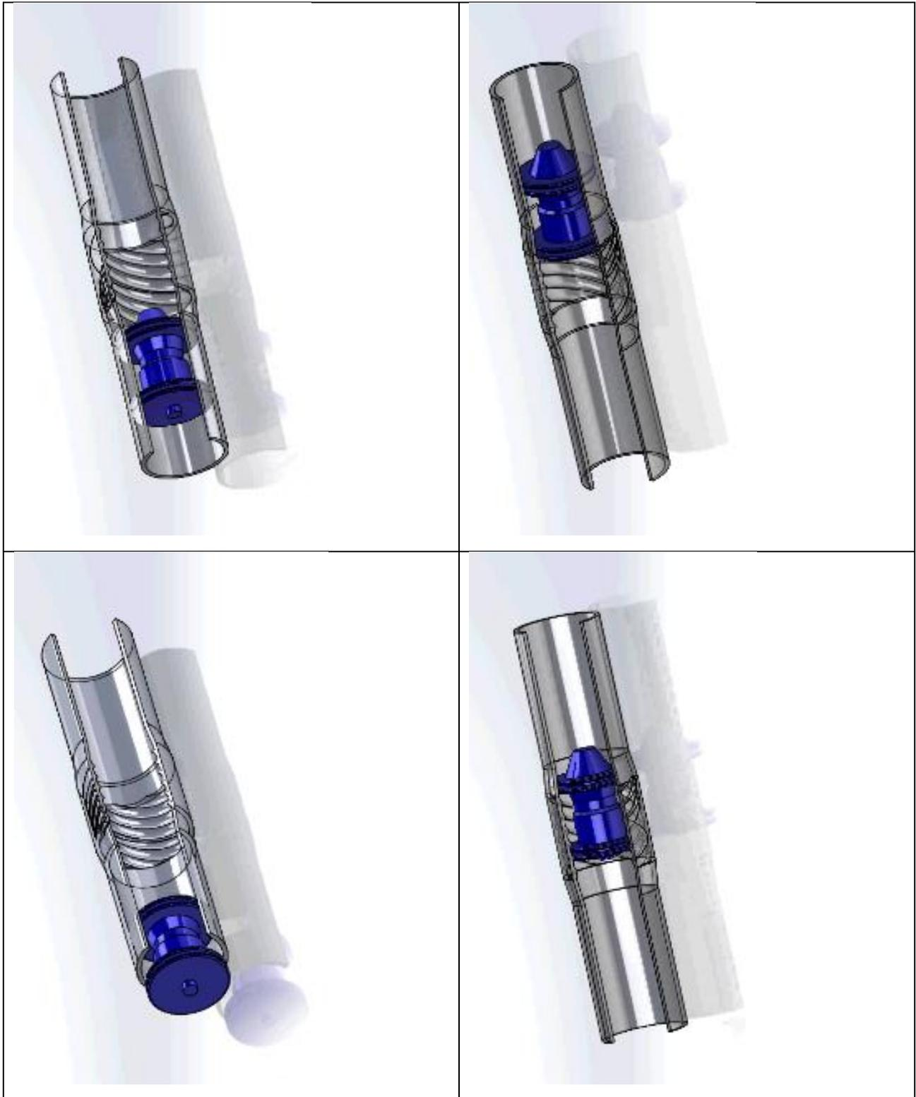
Рисунок 2 – Пояснение процесса прохождения устройства СОД через завихритель
