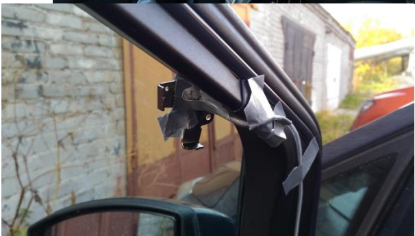
Рис.2. Установка датчиков на окна
