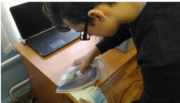
Рис.5. Прогрев утюгом обернутую глянцевой бумагой заготовки струей холодной воды
