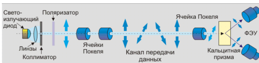
Рис. 1. Схема практической реализации квантовой криптографии
