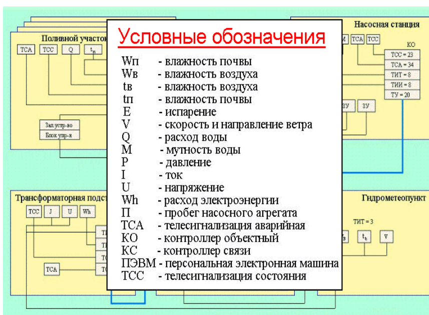
Рисунок 5. Структурно-функциональная схема АСУ ТП орошения
