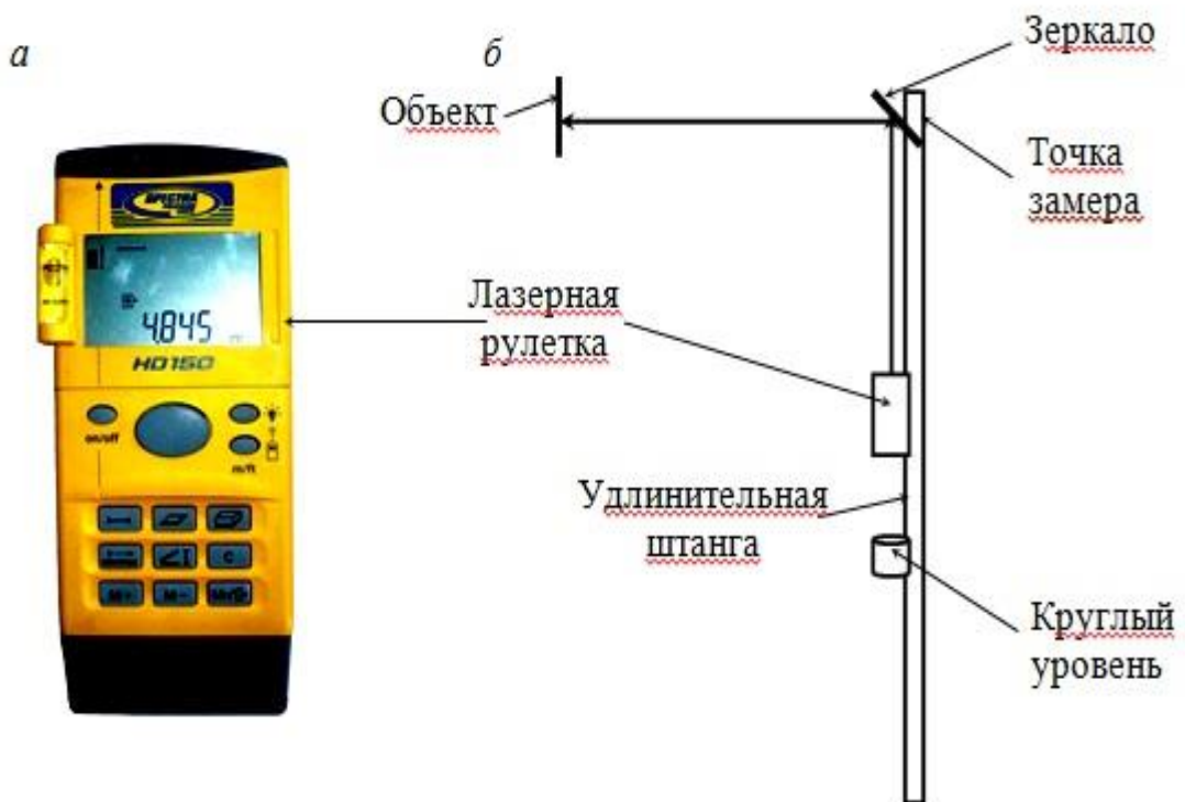
Рисунок 16. Лазерная рулетка HD 150 (а) и схема лазерно-зеркального устройства ЛЗУ (б)
