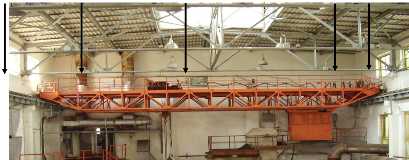
Рисунок 23. Схема фотографического способа определения стрелы прогиба
