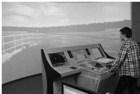
Рисунок 2. Полнофункциональный навигационный тренажер для подготовки судоводителей
